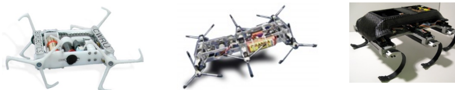
Slika1. Roboti sa wheg konceptom: a) Mini-Whegs b) WHEGS I [7] i c) Edubot [8,9]
